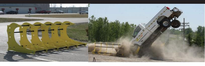
ラプターはスチール製の車両止めです。突進してくる不審車両をブロックし、侵入を防ぎます。出荷時は、スキッドに分解して運搬されます。 組み立て式で、付属の道具を使えば、専門の技術は必要としないため、誰でも簡単に設置することができます。 地面に固定をしないので、フォークリフトなどで再設置が可能です。向こう側を見渡せる設計になっており、背後に人が隠れたりできないようになっています。チェーンキットは、いくつかのユニットを連結させより強固にしたり、特定の場所に固定するために使用します。
